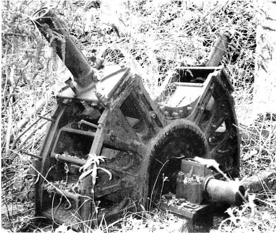
Fig 29 - Défibreux Morel-Bergès ayant fonctionné sous la chute de 500 m du Vors
