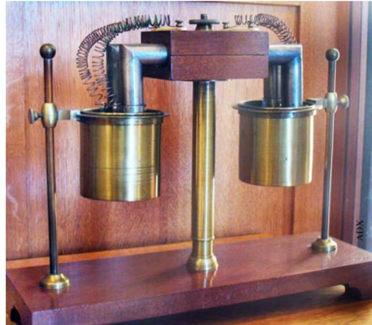
a2 Pile thermoélectrique de Pouillet
