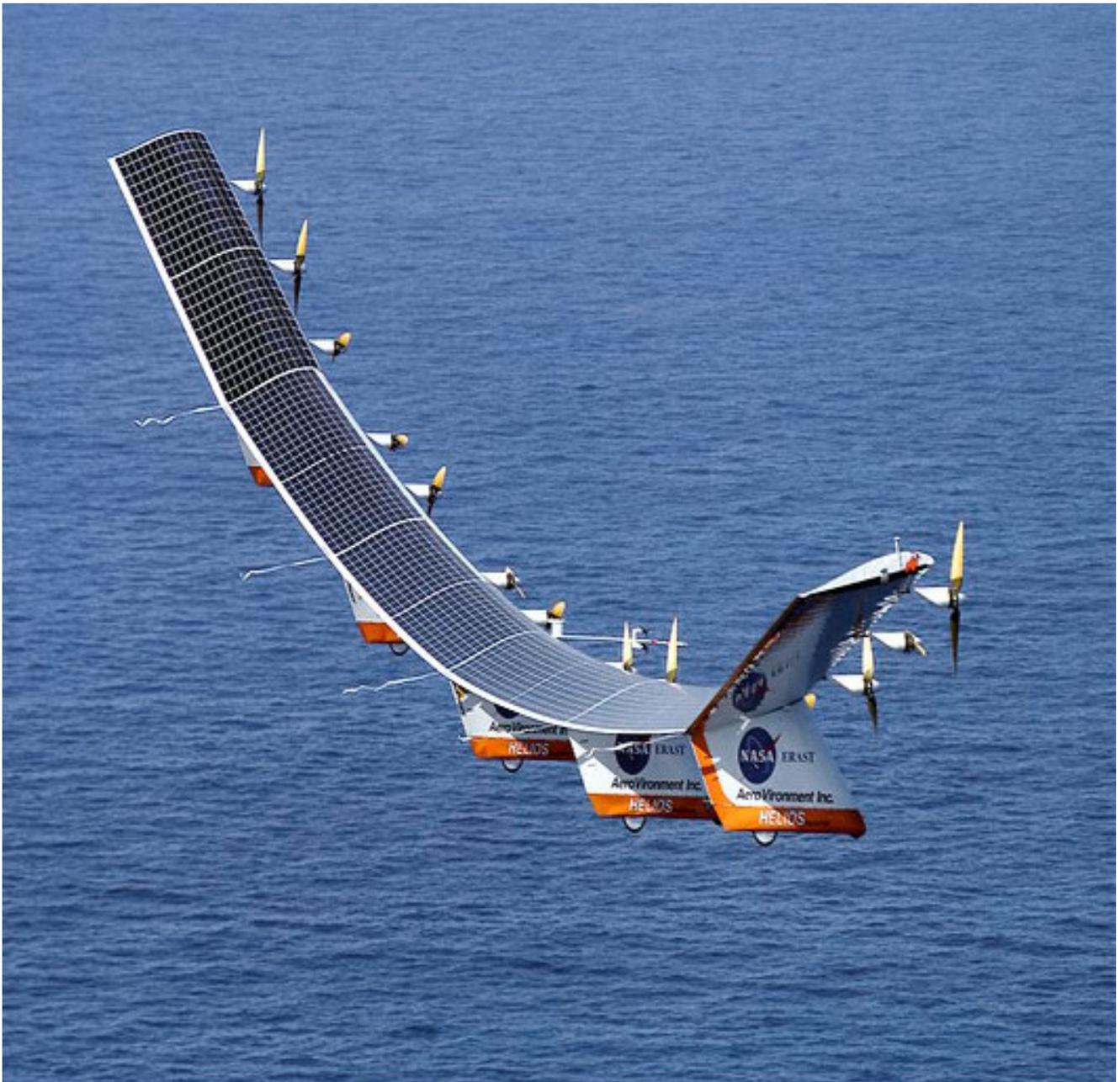
L'avion à propulsion photo-électrique
