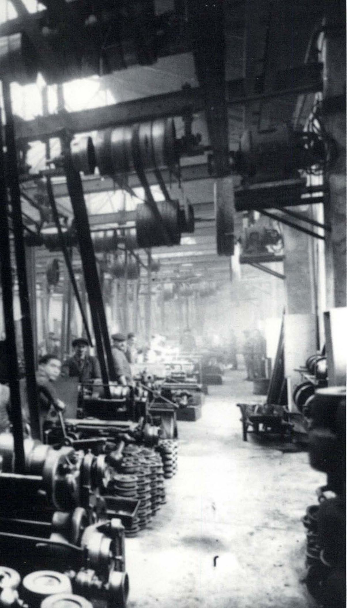
L'atelier de décolletage, vers 1925. On remarque la concentration des courroies et des poulies qui ne disparaîtront qu'après la Seconde Guerre mondiale.
