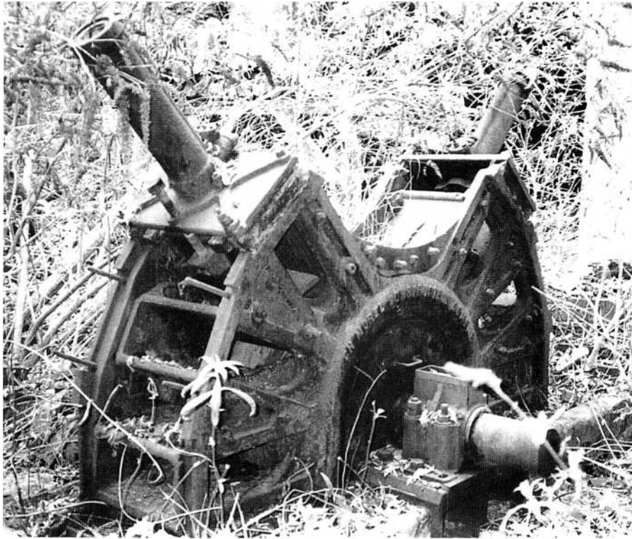
Fig 29 - Défibreur Morel-Bergès ayant fonctionné sous la chute de 500 m du Vors 1892
