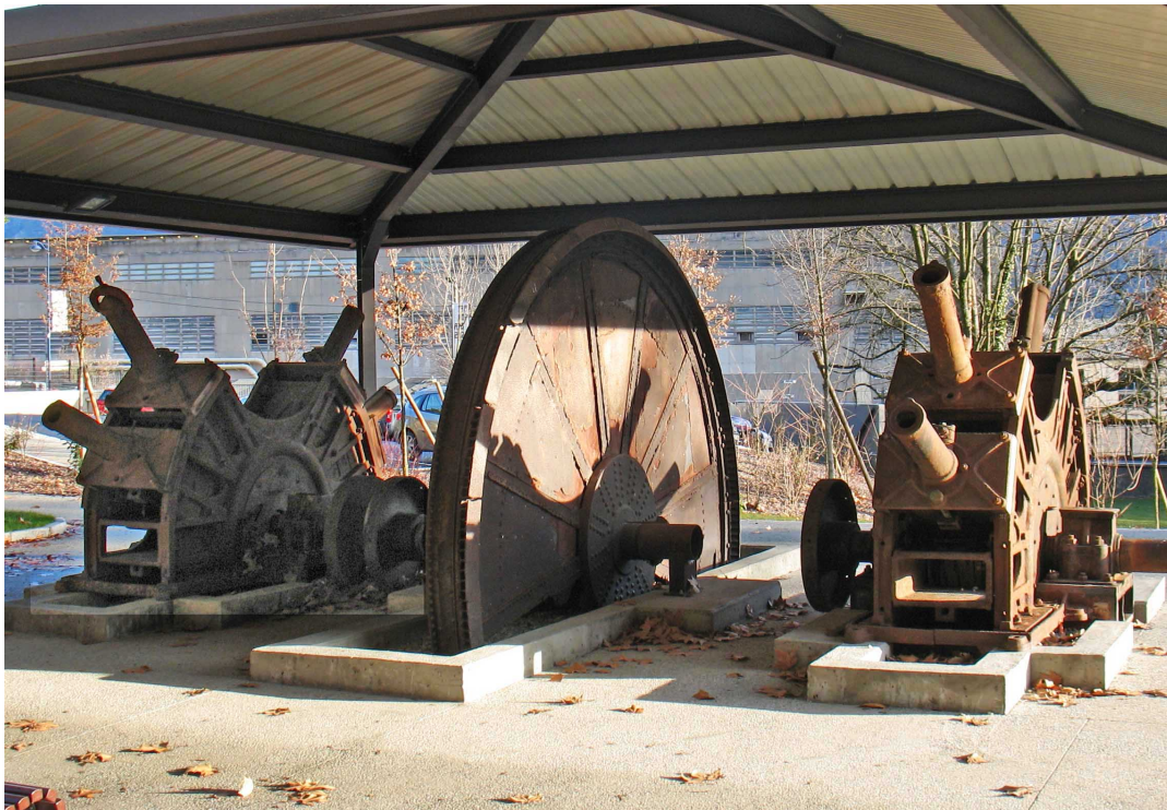
Fig. 48 - Turbine « parapluie » de 500 cv , construction Brenier. entraînant deux défibreurs Morel, découverts par l'auteur en 1996 dans le haut de l'ancienne l'usine (1891) et remplacés au musée Bergés en 2008
