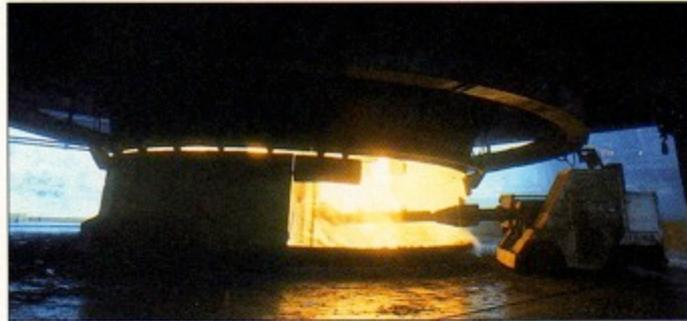
Four à silicium de 23 MV à l'usine Pechiney Electrometallurgie des Clavaux (photo PEM).
